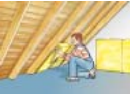
Hőszigetelés a szarufák között
